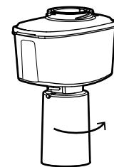
Распакуйте и установите новый модуль в отверстие воронки так, чтобы выступы модуля попали в пазы на воронке, поверните его до упора.
