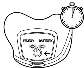
Для обнуления отсчета ресурса удерживайте кнопку включения в течение 3 секунд — светодиоды включаются на 1 секунду и погаснут.
