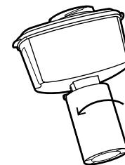
Поверните старый модуль против часовой стрелки и выньте из отверстия воронки.
