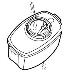
Промойте водой корпус, воронку и уплотнение блока электроники.
