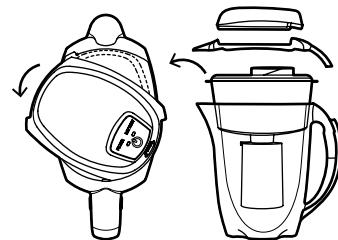
Снимите с водоочистителя крышку и выньте воронку.
