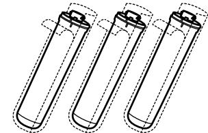
Распакуйте новые сменные модули. Не забудьте снять термоусадочную пленку.
