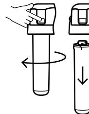
Нажмите до упора и удерживайте стопорную кнопку на крышке водоочистителя, выкрутите использованные модули.
