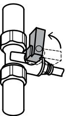
Перекройте воду перед водоочищителем, чтобы вода не поступала в фильтр.
