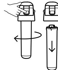
Нажмите до упора и удерживайте стопорную кнопку на крышке водоочистителя, выкрутите использованный модуль.
