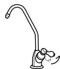
Откройте кран для чистой воды. При помощи узла подключения отрегулируйте расход воды 1,5 л\мин.
