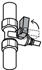
Перекройте воду перед водоочищителем, чтобы вода не поступала в фильтр.
