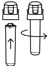
Вставьте новый модуль в гнездо коллектора до упора и, слегка надавливая, поверните модуль до щелчка.
