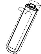
Распакуйте новый сменный модуль. Не забудьте снять термоусадочную пленку.
