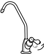
Откройте кран для чистой воды, чтобы сбросить давление внутри фильтра.
