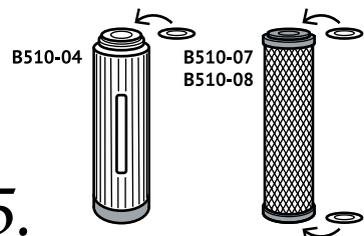
Убедитесь в наличии уплотнительных прокладок на новом сменном модуле (одной на модуле B510-04; двух — на модуле B510-07, B510-08).
