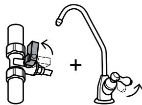
Перекройте воду перед водоочистителем и откройте кран для чистой воды, чтобы сбросить давление.
