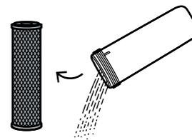
Выньте использованные фильтрующие модули и промойте стаканы от грязи.
