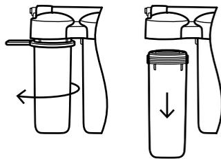
Отверните пластиковым ключом стаканы от коллектора водоочистителя.
