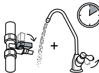
Откройте воду. При помощи узла подключения отрегулируйте расход воды 2 л/мин. Пропустите воду в течение 10 минут.
