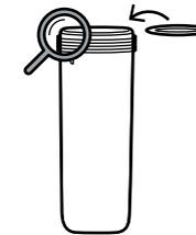
Проверьте целостность и правильность установки уплотнительных колец в стаканах.
