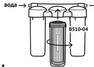
Отверните пластиковым ключом средний стакан от коллектора водоочистителя. Поставьте в стакан модуль B510-04 красной крышкой вниз.
