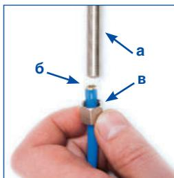
9. Подсоедините к крану (а) конец трубки с запрессованной латунной втулкой (б) и закрепите крепежной гайкой (в)
